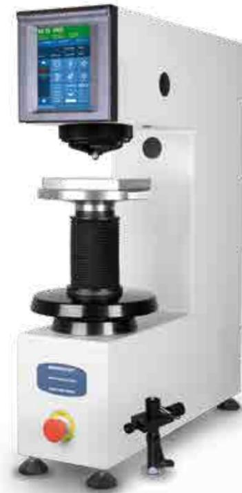
自動測定による全自動ブリネル硬度試験機
