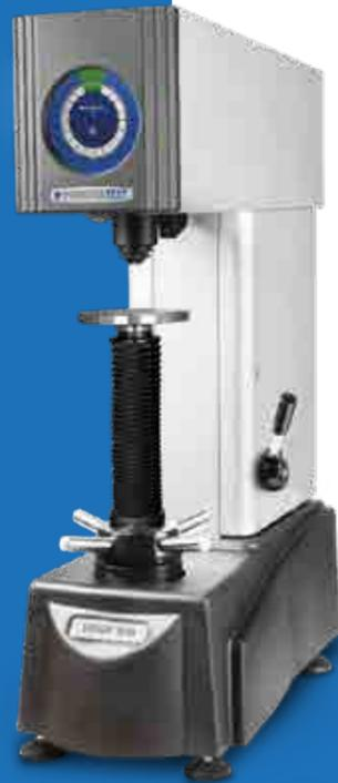
長期間高品質な装置、精密インジケータからの読み取りで従来のデッドウェイトシステム(200 AR)またはこのクラスで特徴的なロードセルクローズドループシステムである200 ACL。
